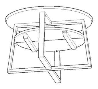
**4.** Schieben Sie das Fachbrett möglichst waagrecht im Fußgestell bis über die Bohrungen nach oben. Stecken Sie nun die 4 Fachträger in die Bohrungen und lassen Sie dann das Fachbrett vorsichtig nach unten, bis es satt auf den Fachträgern aufliegt.
