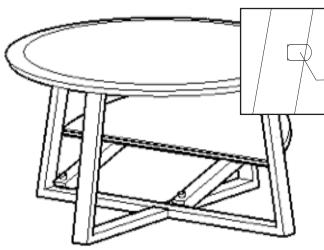
1. Entfernen Sie die Abdeckkappen der 4 Bohrungen im Fußgestell.
