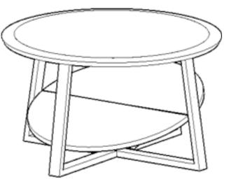
3. Fädeln Sie die zweite Fachbretthälfte ein und verbinden Sie sie mit der ersten. Dabei müssen einerseits Nut und Feder der beiden Hälften exakt zusammenpassen, sowie andererseits die Dübel der Gratleisten in die Bohrungen des Fachbretts.
